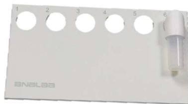
L'accessoire « Elbow Stand » a été conçu pour positionner coudes et béchers verticalement pour éviter de mélanger à nouveau l'échantillon à l'évaporat après l'évaporation ou des acides après le processus de purification.
