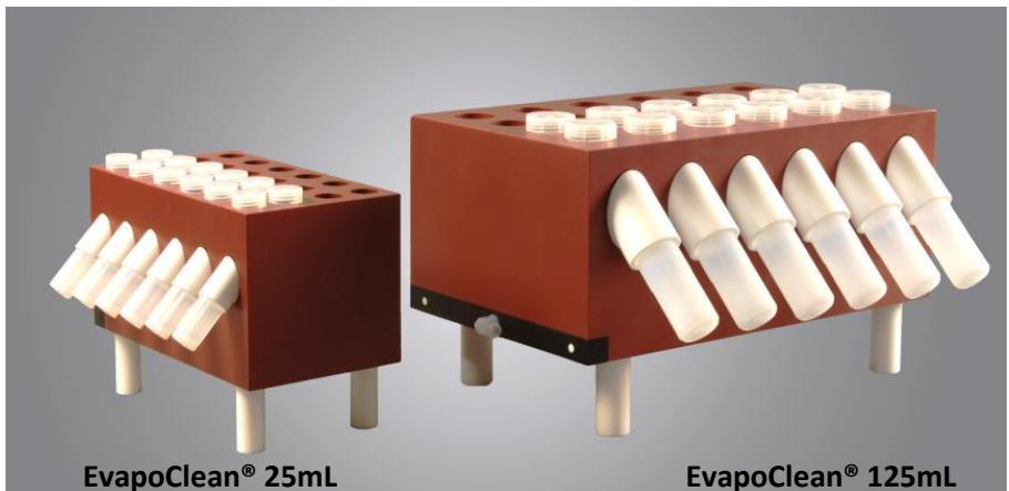
Tous nos Evapoclean sont équipés d'une protection latérale pour augmenter la qualité du chauffage et la protection de l'utilisateur.
